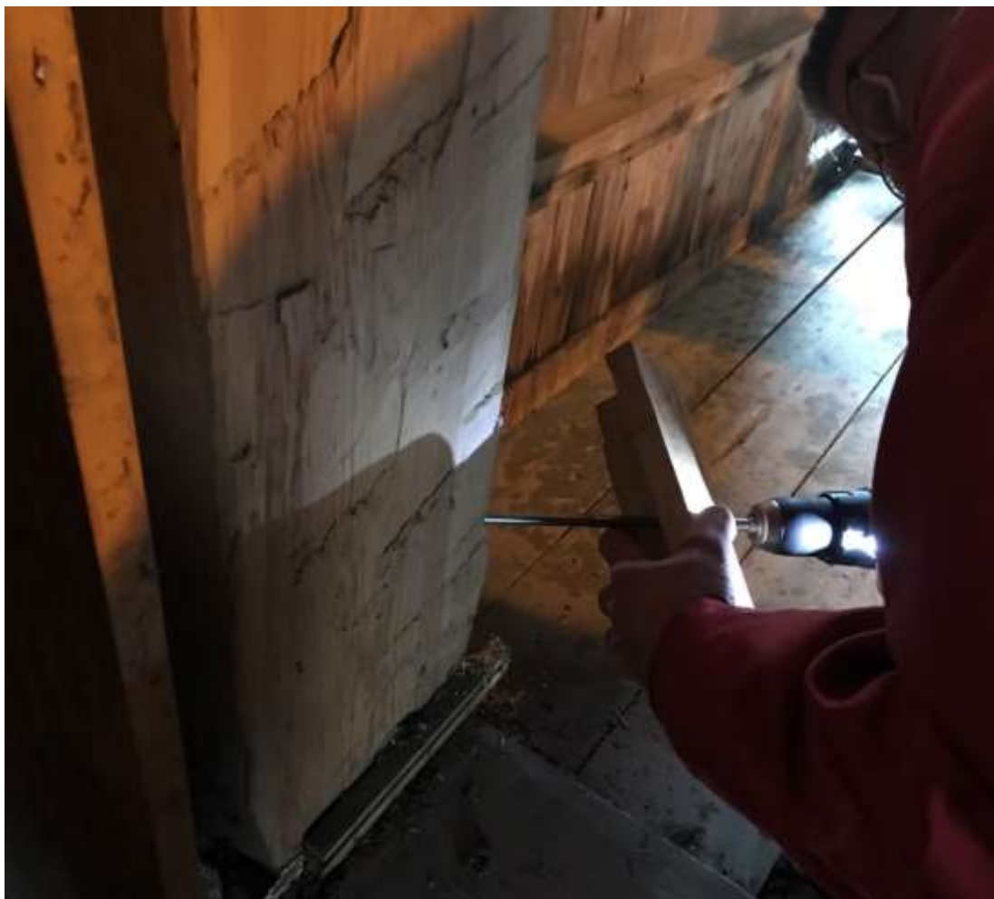
Fig. 8. Borrhåttagning i stolpen söder om mitten i västra muren (prov 1).
