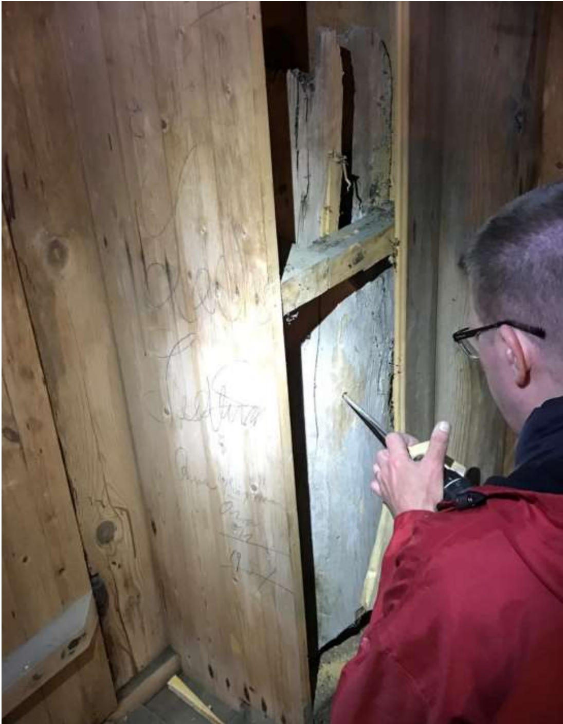
Fig. 12. Borrprovtagning i sydvästra stolpen (prov 2). Den bruna fläcken på träytan bedömdes vara en tjärfläck.
