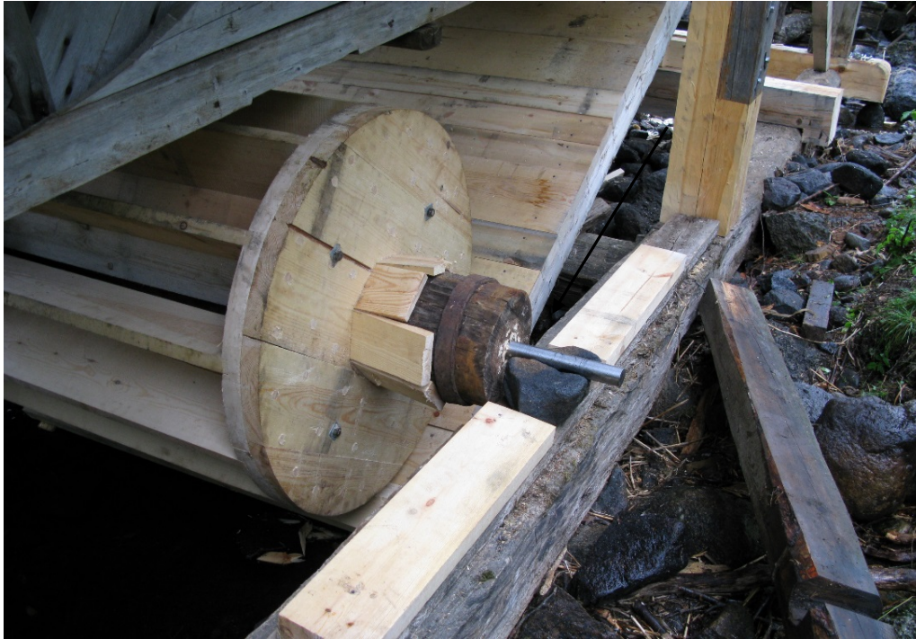
Vevaxelns axeltapp vilar i den gamla lagerskålen av sten som återfanns när man rensade i ån kring sågbyggnaden. Foto Stig Nilsson.
